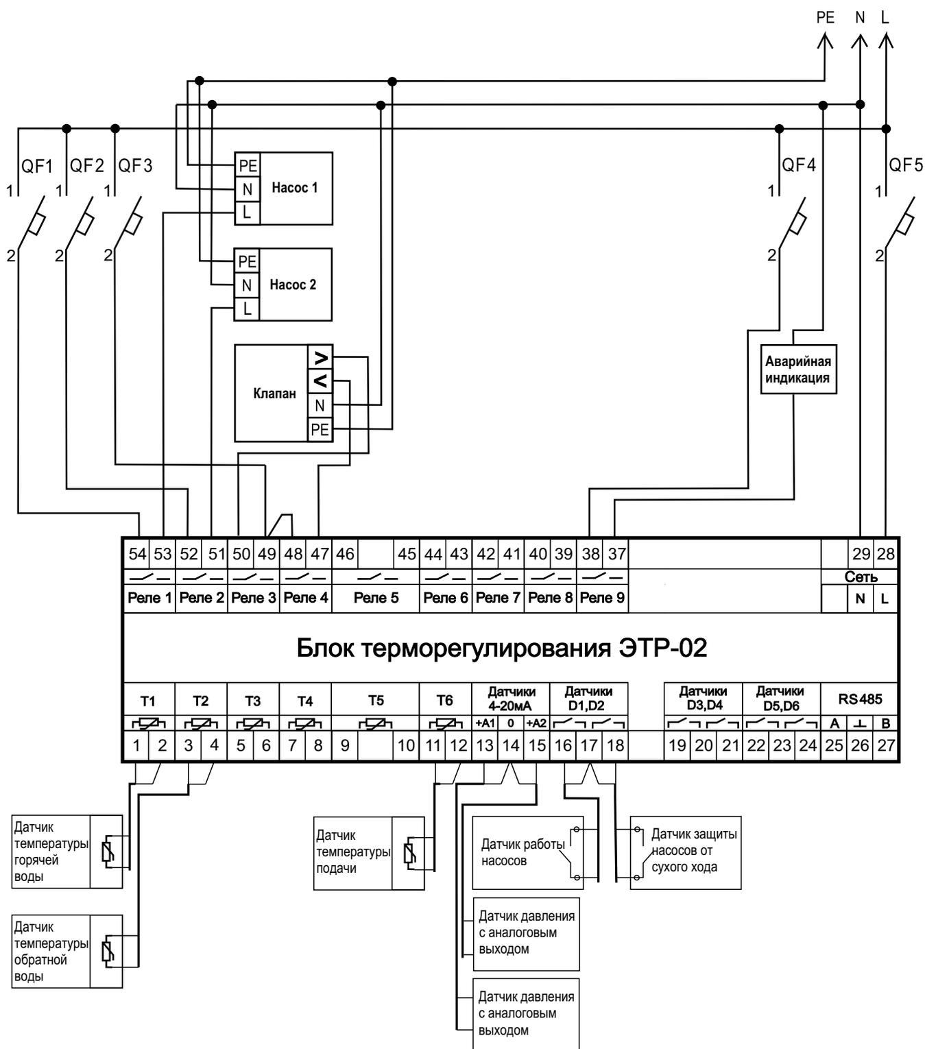
Рисунок А6. Схема подключения регулятора ЭТР-02 (Программа 6)
