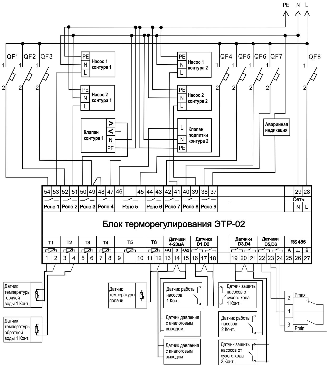
Рисунок А8. Схема подключения регулятора ЭТР-02 (Программа 8)
