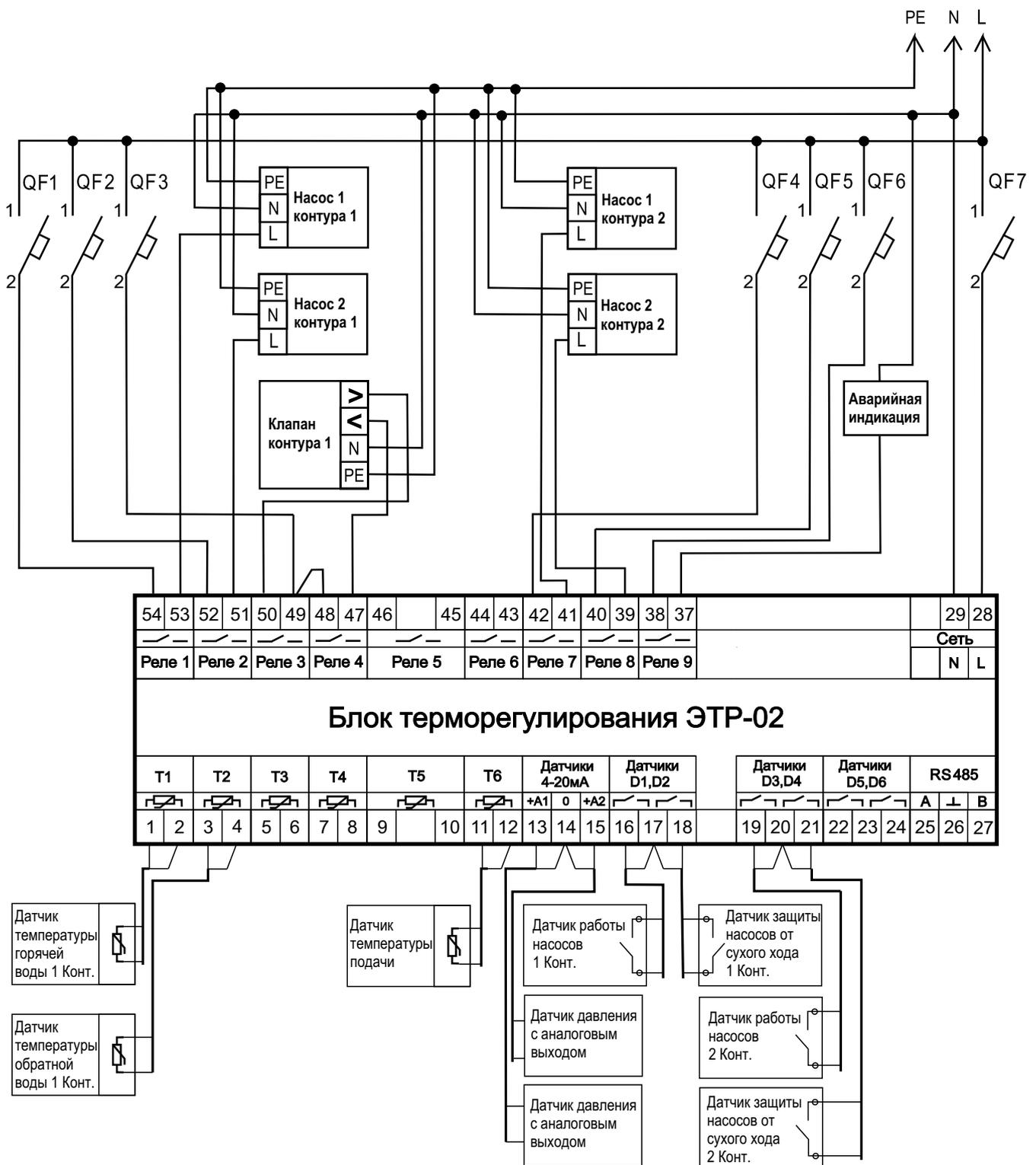
Рисунок А9. Схема подключения регулятора ЭТР-02 (Программа 9)
