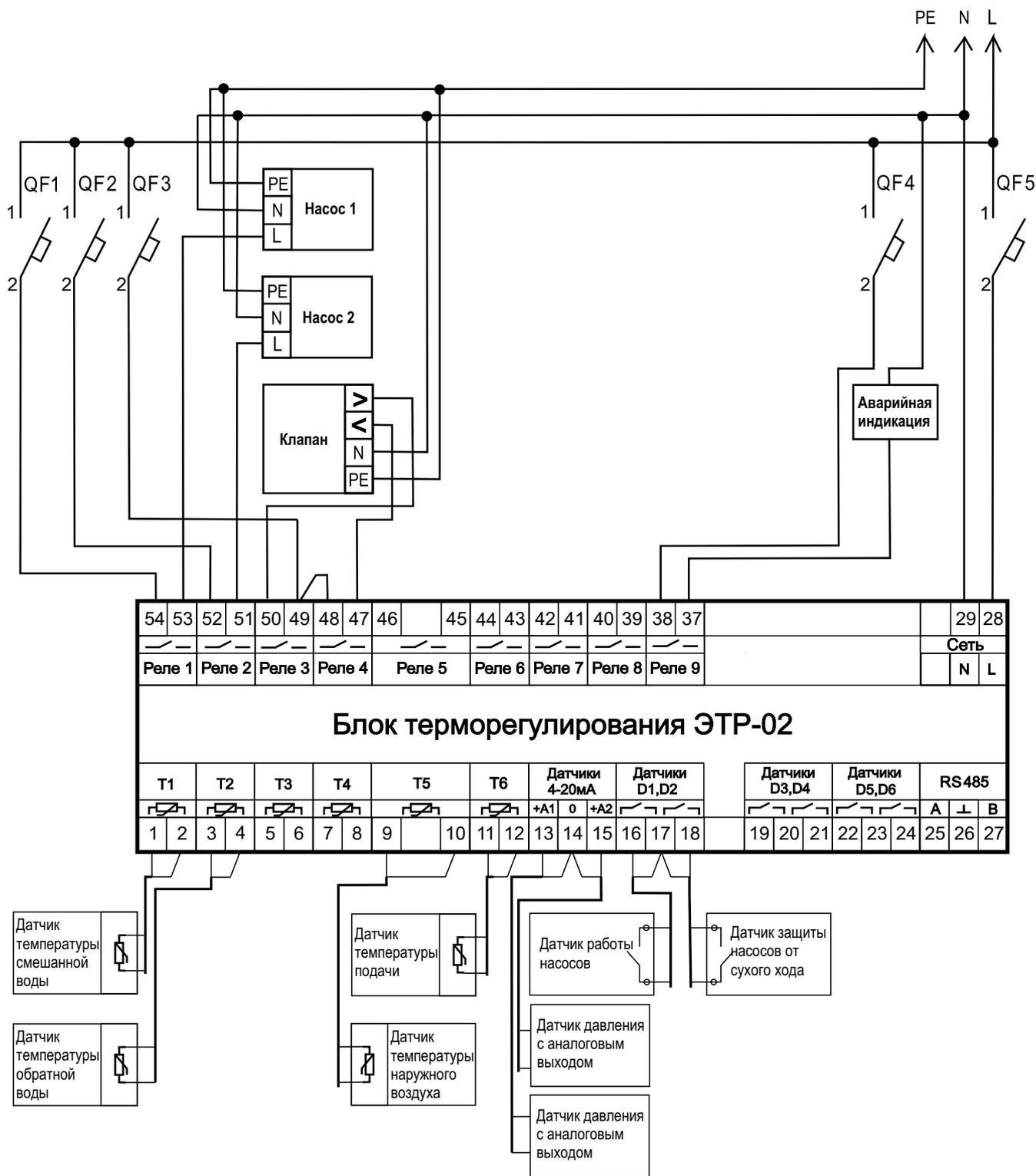
Рисунок А1. Схема подключения регулятора ЭТР-02 (Программа 1)
