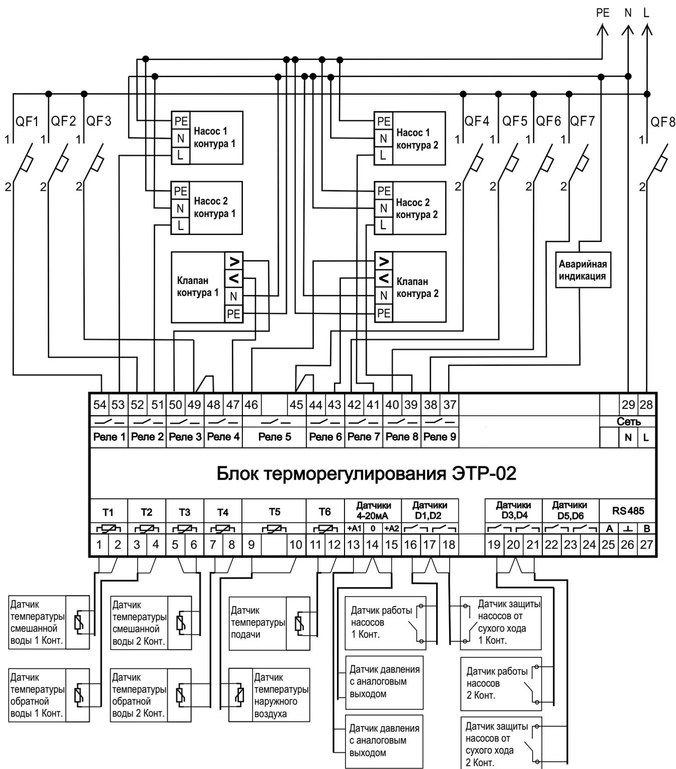
Рисунок А2. Схема подключения регулятора ЭТР-02 (Программа 2)
