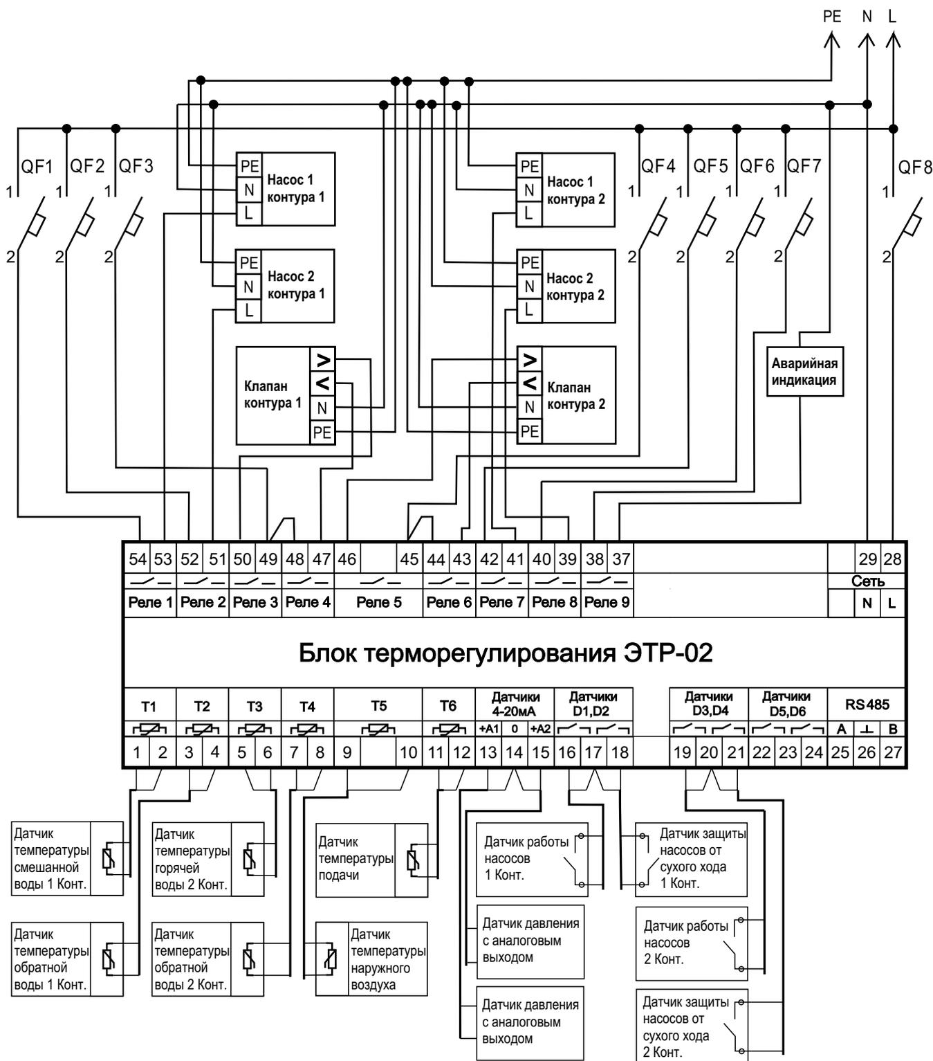
Рисунок А3. Схема подключения регулятора ЭТР-02 (Программа 3)
