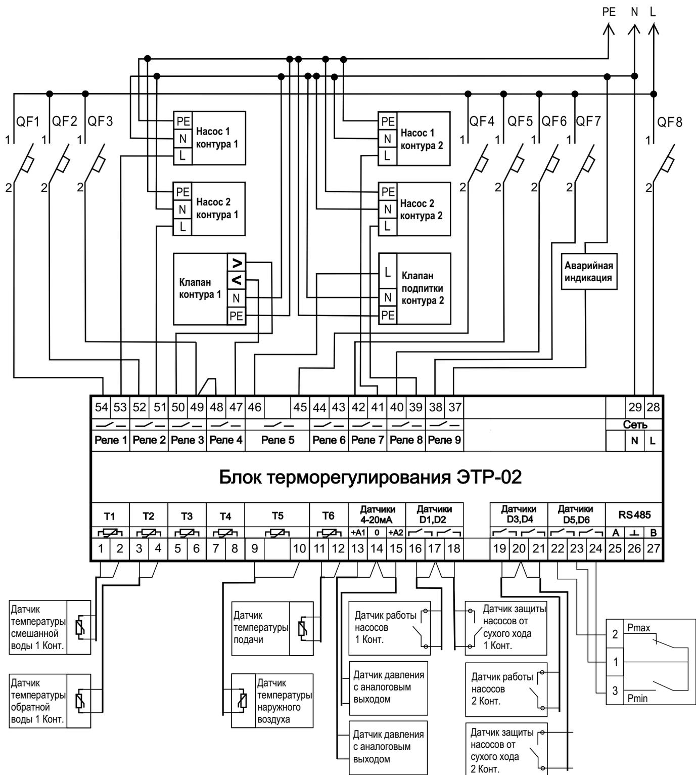
Рисунок А4. Схема подключения регулятора ЭТР-02 (Программа 4)
