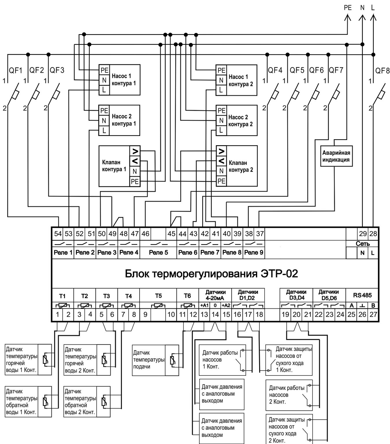
Рисунок А7. Схема подключения регулятора ЭТР-02 (Программа 7)
